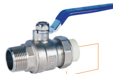
9270 外丝单活接PPR球阀 15× \phi 20 20× \phi 25 25× \phi 32 32× \phi 40 注: 可选配PB、PERT接头
